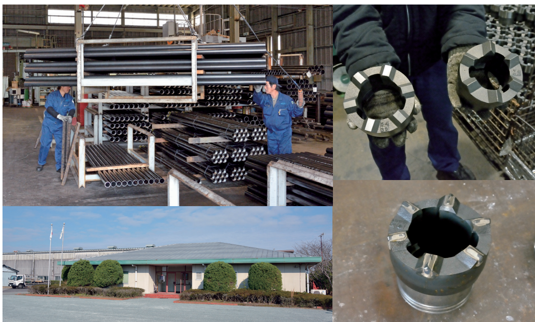
【写真左上】トンネルの補強に使うパイプ。工事現場では数本つなげて使用【写真左下】本社社屋と工場(奥)【写真右上】加工前のビット。左手のものから右手のものに加工【写真右下】完成したビット。6つの刃を銀の合金でろう付け
