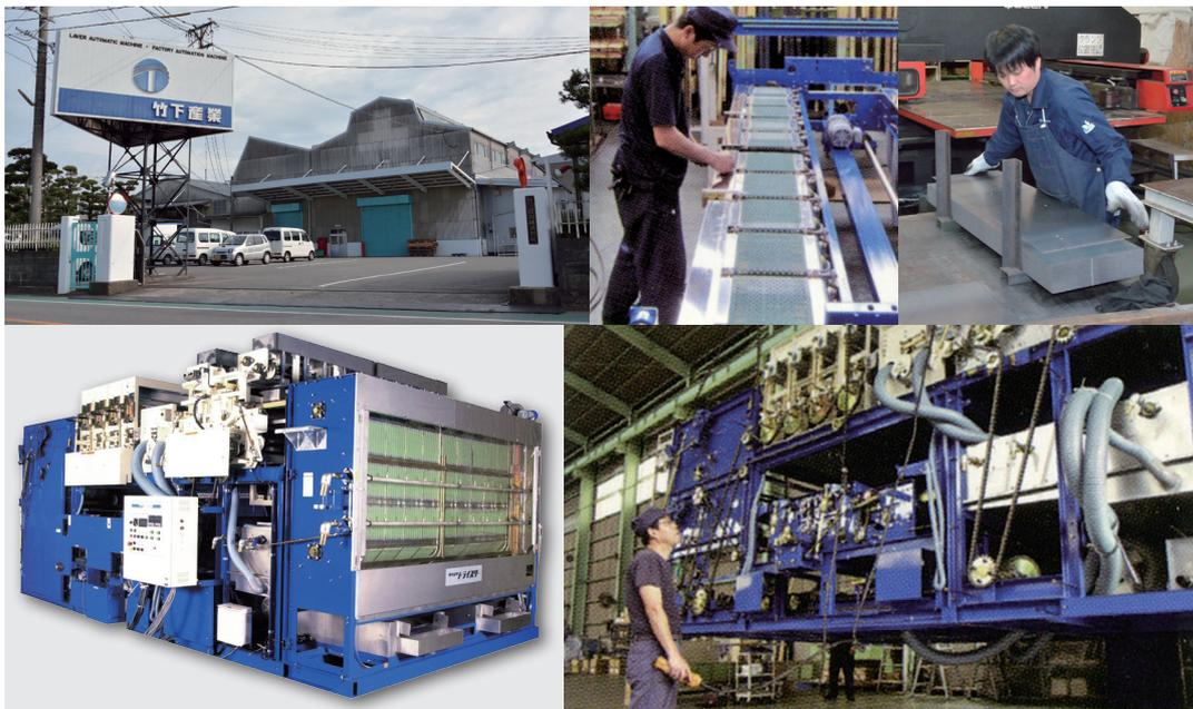
【写真左上】本社工場【写真左下】高さ約2.7m、長さ約19mにもなる最大ののり製造機【写真中上】のりを乾燥させるすのこのラインを製作【写真右上】自社で部品を生産【写真右下】のり製造機をつり上げ従業員が下からチェック
