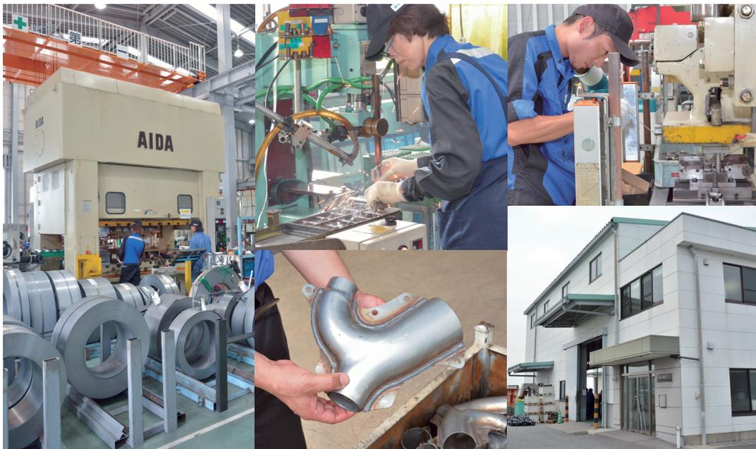
【写真左】手前にあるロール巻の薄い金属板を奥の大型プレス機械で加工【写真中上】従業員が部品を溶接【写真中下】自動車のマフラーに取り付ける部品【写真右上】細い部品を丁寧に加工する従業員【写真右下】本社工場と工場
