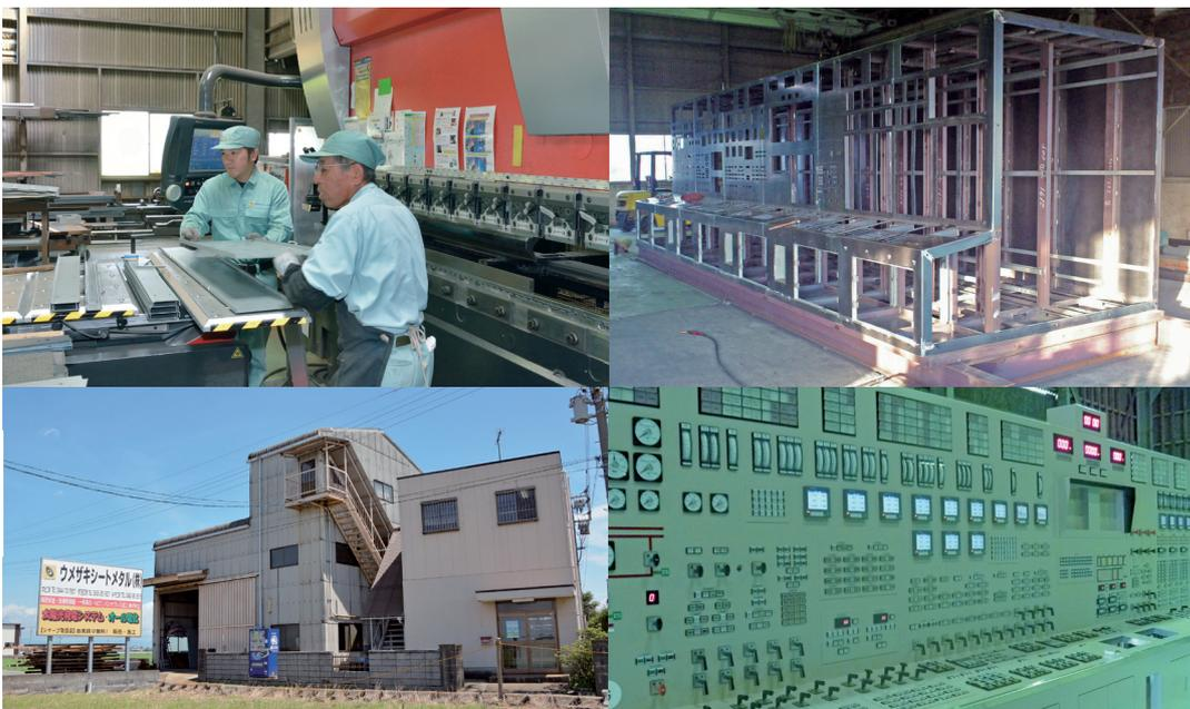
【写真左上】金属板を機械で加工する従業員【写真左下】本社社屋と工場【写真右上】長さ8m、高さ2.3mの巨大な制御盤を製作【写真右下】計器類などを取り付けた8mの制御盤。発電所などで使用されるという
