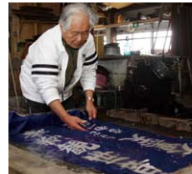
【写真左上】生地にのり付けをする田中さん【写真右上】のりで描いた模様。染料が生地に染み込まないようのり付けする【写真右】水でのりを落とす作業。うまく文字や模様が出ているか毎回緊張するそうです
