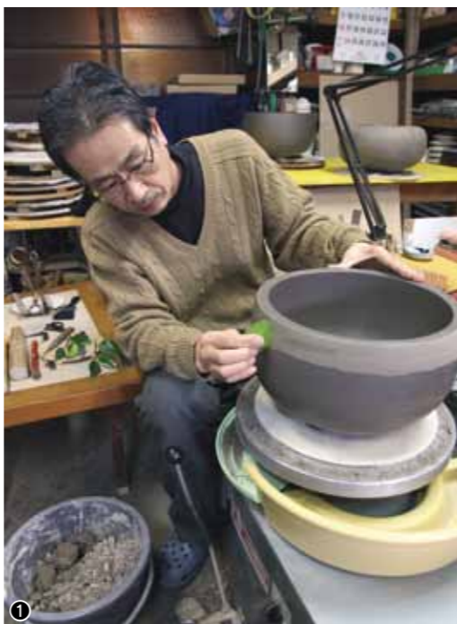
①風炉を制作する伊東征隆さん。椿の葉などを使い表面を整える②「空窯」と呼ばれる窯。松の木を使い約12時間かけて焼き、その後1週間かけていぶす。窯の上に瓦を敷き詰め、煙の出方を見ながら焼き方を調整していく③黒地に白い雲のような模様が入った「縹網雲型」（伊東征隆作）④さまざまな表情を見せる表面。④は渦のような「縮緬」模様。⑤は雲のような「縹華」模様
