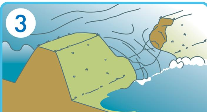
水が増え、水の力に堤防が耐えられなくなると堤防の一部が崩れ始めます。
