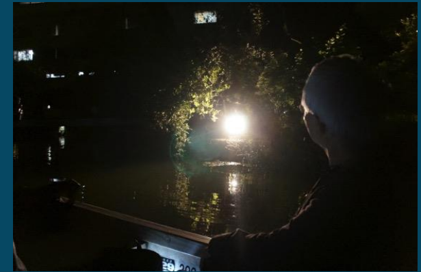
角度がずれてグレアとなっている照明
