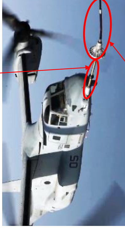
給油器（ドローク） 給油母機側
