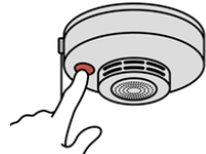
図2 住宅用火災警報器の作動確認の方法
