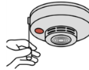
図2 住宅用火災警報器の作動確認の方法
