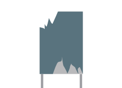
著しい汚損、剥離
